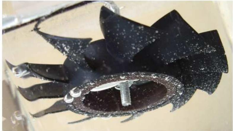
Figure: Résultats : bulles localisées surtout aux endroits où la vitesse est élevée (principe de Bernoulli)
